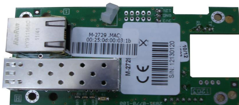
Плата мониторинга M-2729 с видимым адресом MAC
